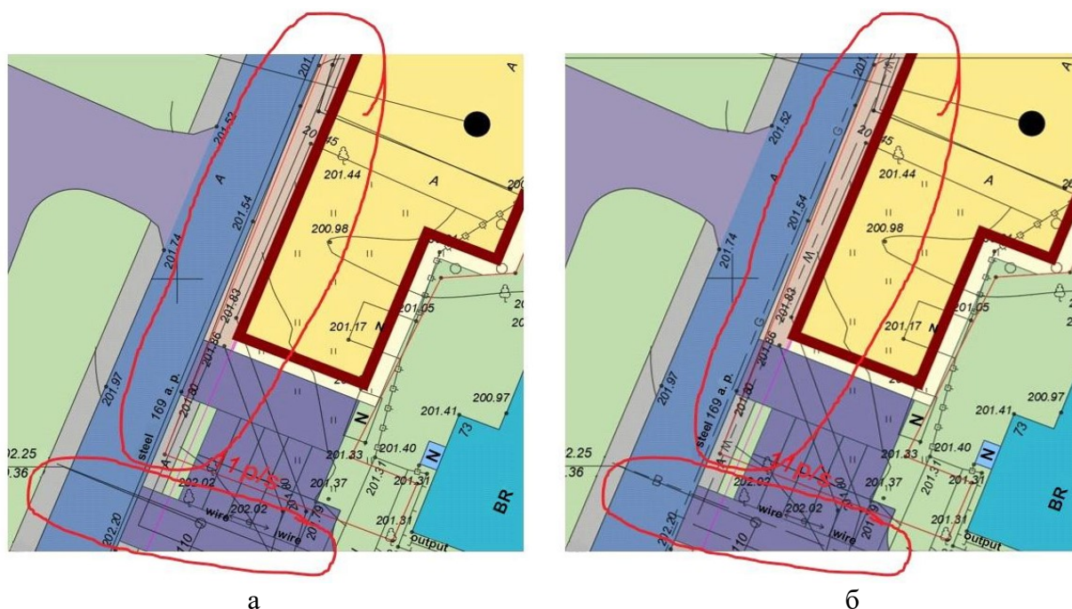
Рис. 7. Некорректное (а) и корректное (б) изображение топографической основы для объекта «Торгово-офисный центр Новотроицкий», Саранск. Масштаб 1: 5 000 Fig. 7. Incorrect (right) and correct (left) image topography of the land plot for the object “Novotroitsky Shopping and Office Center”, Saransk. Scale 1: 5 000
