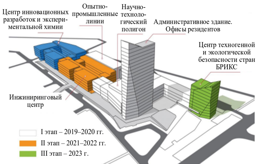
Рис. 41. Этапы строительства ИНТЦ «Композитная долина»
