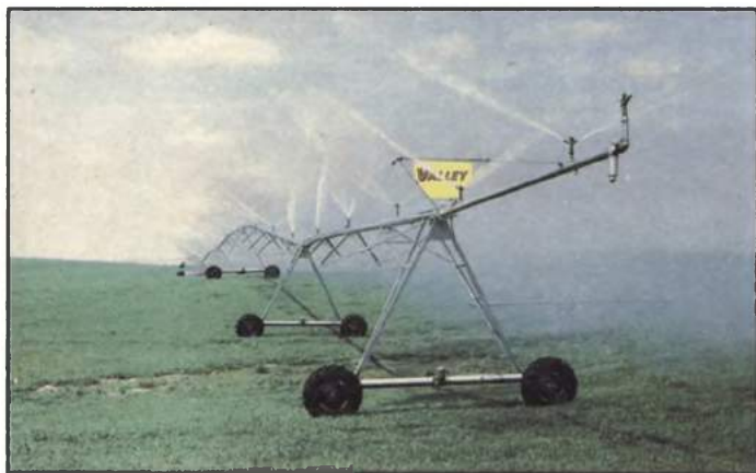
Дождевальная установка на пастбище
